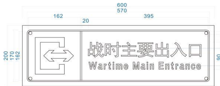
图 3-7 口部提示牌样式及尺寸示例
