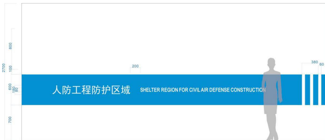
图4-2墙面喷涂标识样式及尺寸示例
