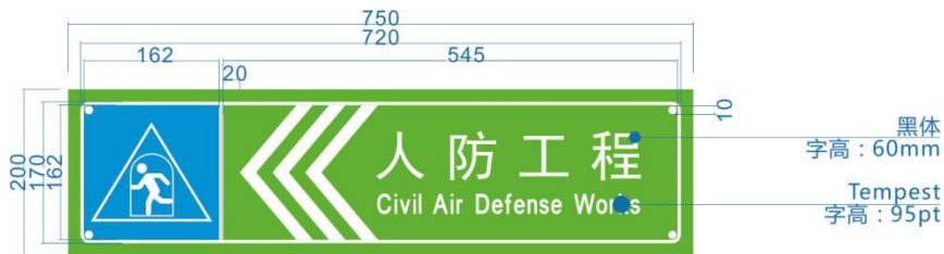
图 3-3 疏散指示牌样式及尺寸示例
