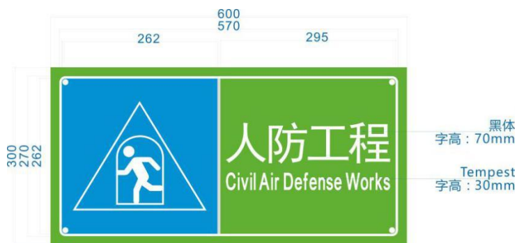
图 3-6 人防工程提示牌样式及尺寸示例
