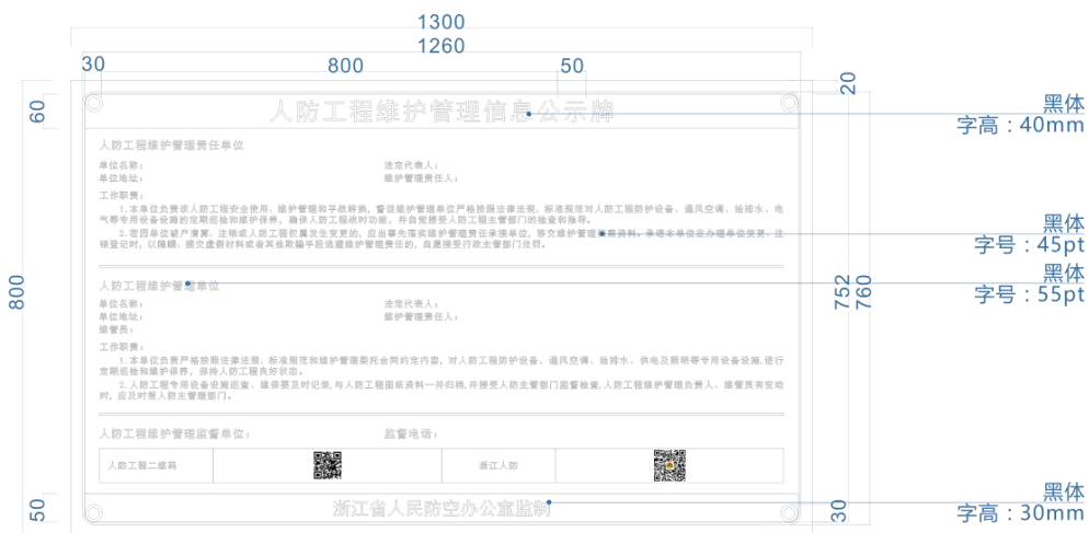
图 2-2 《人防工程维护管理信息公示牌》样式及尺寸示例
