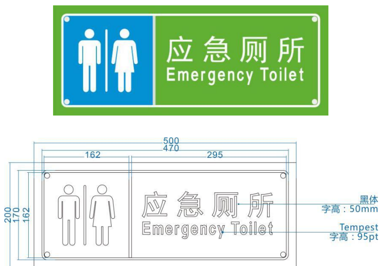
图5-1 转换功能区标识样式及尺寸示例
