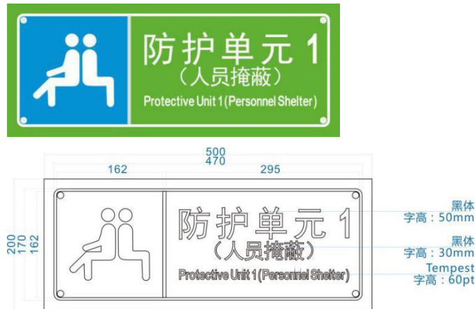
图4-1战时导引标识样式及尺寸示例
