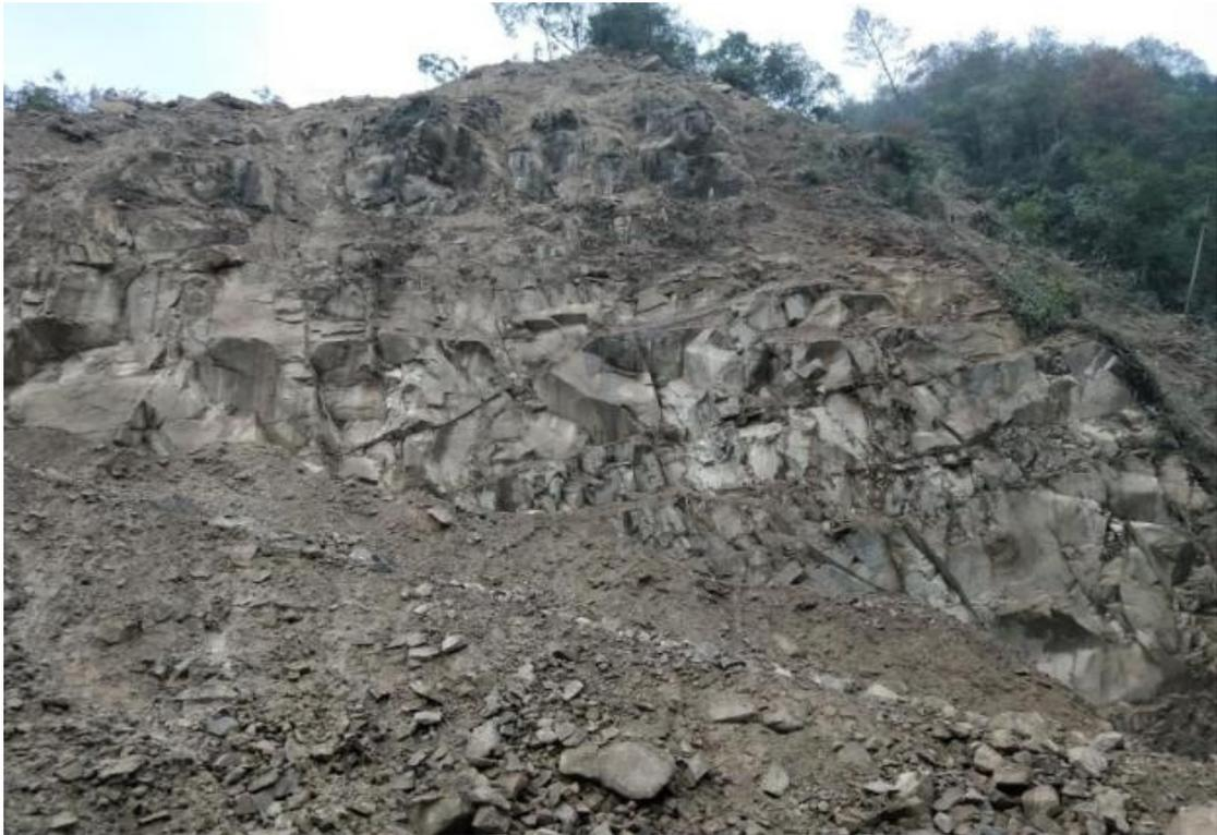
图 3-4 新鲜基岩裂隙
