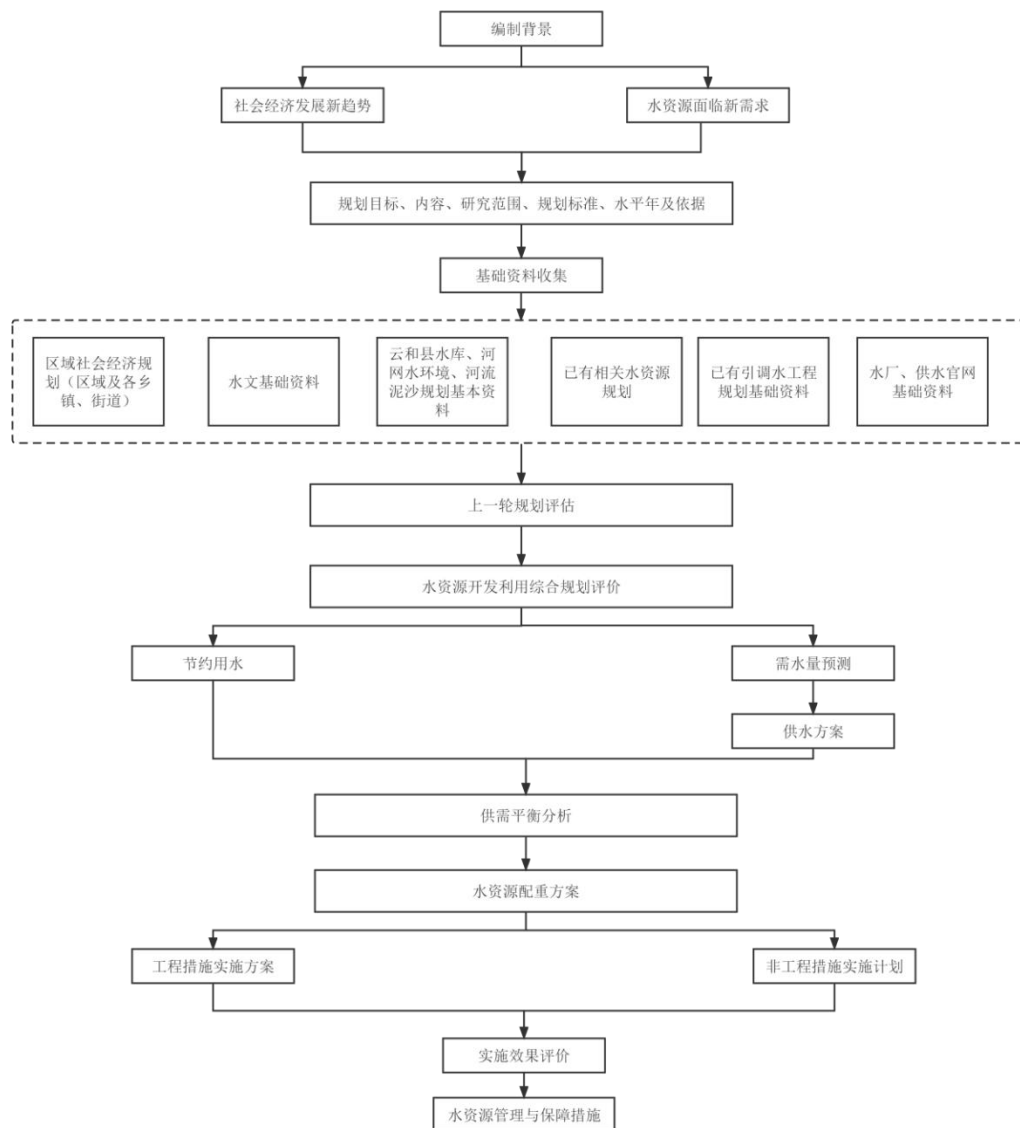
图 2.3-1 云和县水资源节约保护和开发利用总体规划技术路线图
