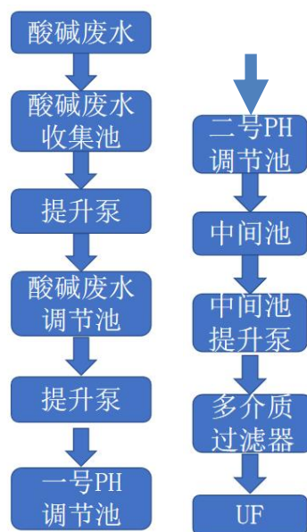
图 4.2.4 酸碱废水处理流程图
