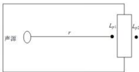
图 4.2.2 室内声源等效为室外声源图例
