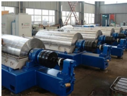
绿水分离公司的卧螺离心式脱水机
