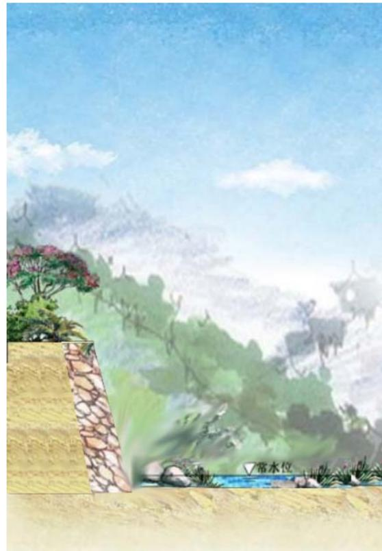
**断面型式三：**生态缓坡。岸坡适宜的种植水生植物、草皮、灌木等，坡脚采用自然块石或卵石护脚。适用于岸坡较缓、土质较好的河段，断面效果图如下：
