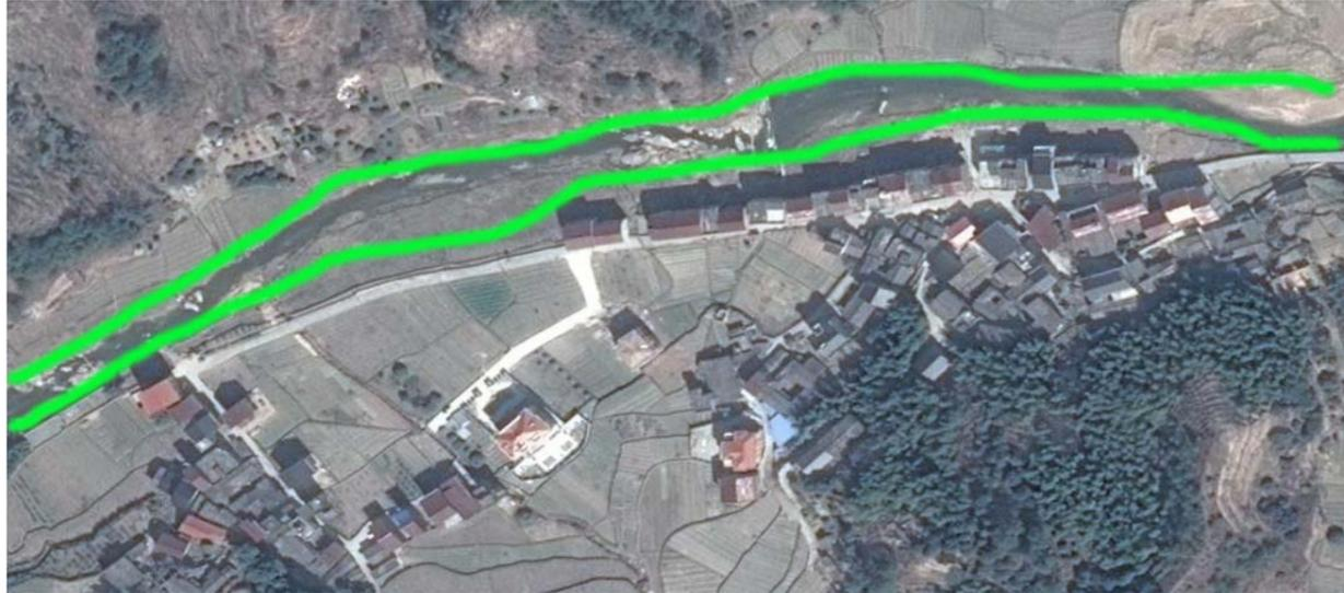
图 6.1-8 丁埠头村左右岸规划堤线图
