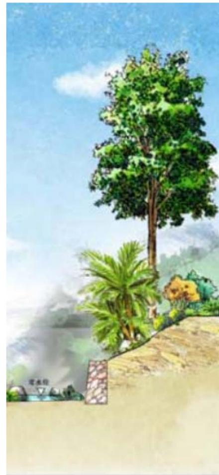
**断面型式二：**卵石挡墙—植物护坡复合式。下部采用卵石挡墙护岸，上部修缓坡采取植物护坡。适用于水流较缓的下游河段，断面效果图如左：
