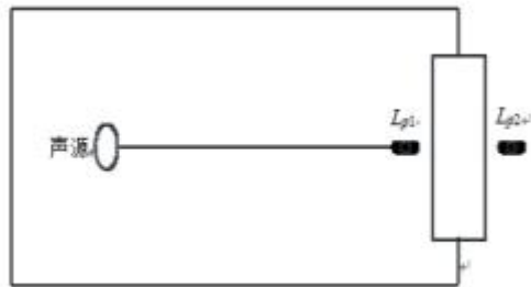
图 4-2 室内声源等效为室外声源图例
