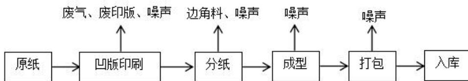
图 2.11-2 瓦楞纸套生产工艺流程图
