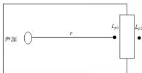
图 4.1 室内声源等效为室外声源图例
