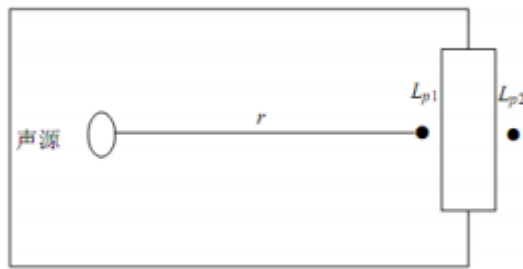
图 6-3 室内声源等效为室外声源图例
