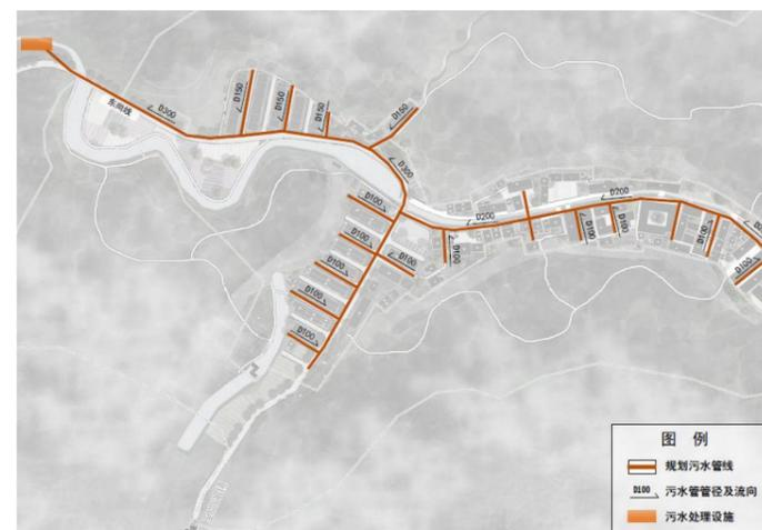
以减少埋深和不设提升泵站为主要原则，充分结合实际地形，合理布置，污水经收集后进行集中处理，排水坡度在满足规范的情况下，尽可能接近道路坡度。
