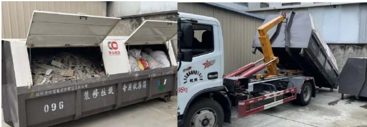
图 8-7 装修垃圾收集箱示例
