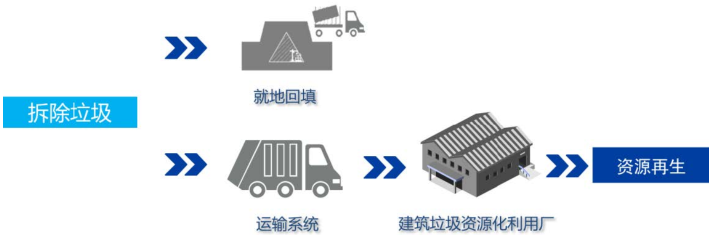
图 8-1 拆除垃圾收运体系图
