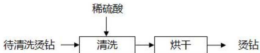
图 3.1-5 清洗工艺流程及产污点位示意图
