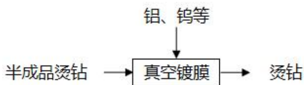
图 3.1-3 烫钻真空镀膜工艺流程及产污点位示意图
