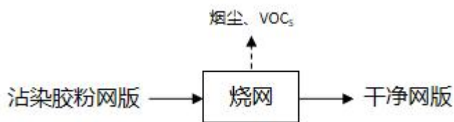
图 4.2-3 项目烧网工艺流程图
