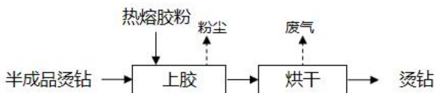
图 3.1-4 上胶工艺流程及产污点位示意图
