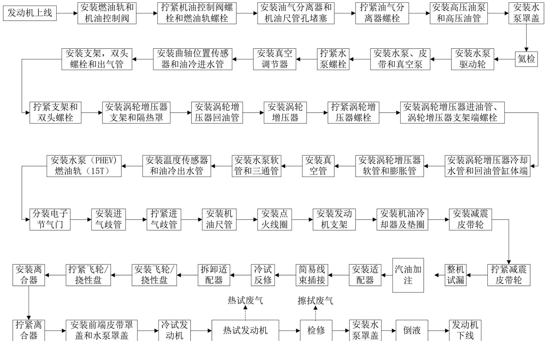
图 3.5-10 总装—final 生产流程及产污环节图
