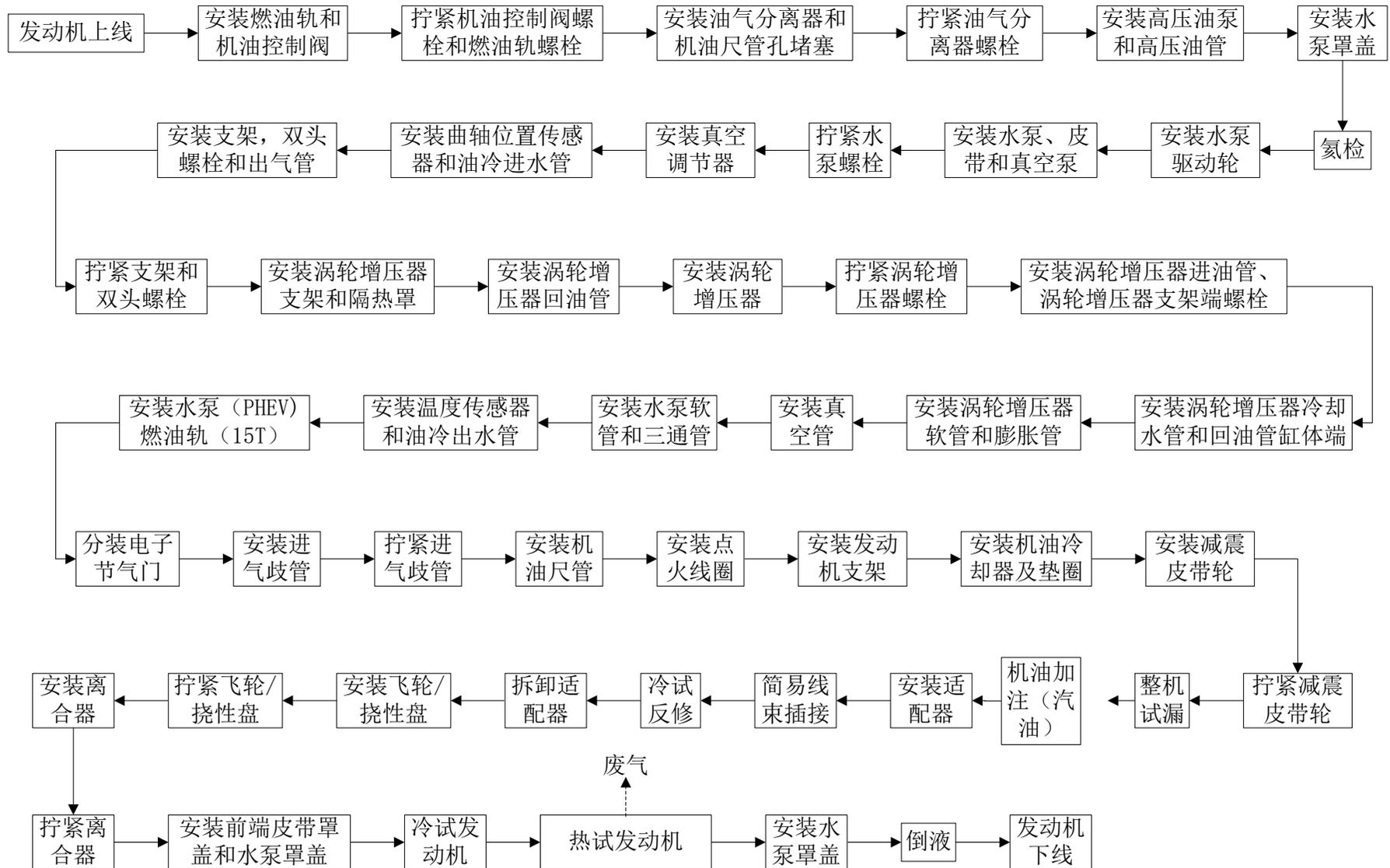
图 3.1-8 总装—final 生产流程及产污环节图
