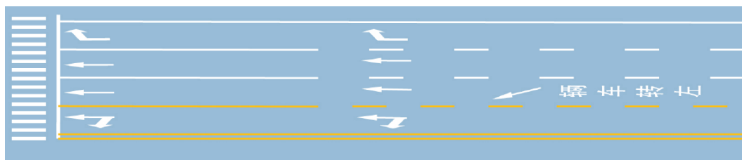
图 8.4.2-2 路中式公交专用道与左转车辆共用的进口道交通标线
