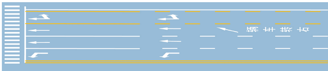
图 8.4.2-1 路侧式公交专用道与右转车辆共用的进口道交通标线
