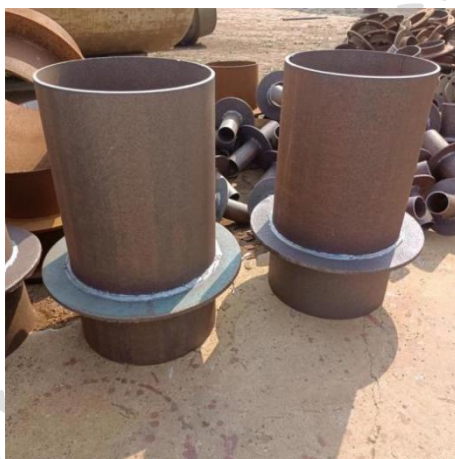
图 45 止水环焊缝饱满
