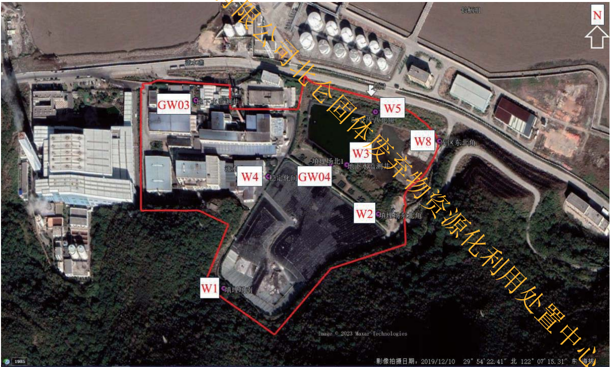
图 3.10-1 厂区地下水监测井点位图
