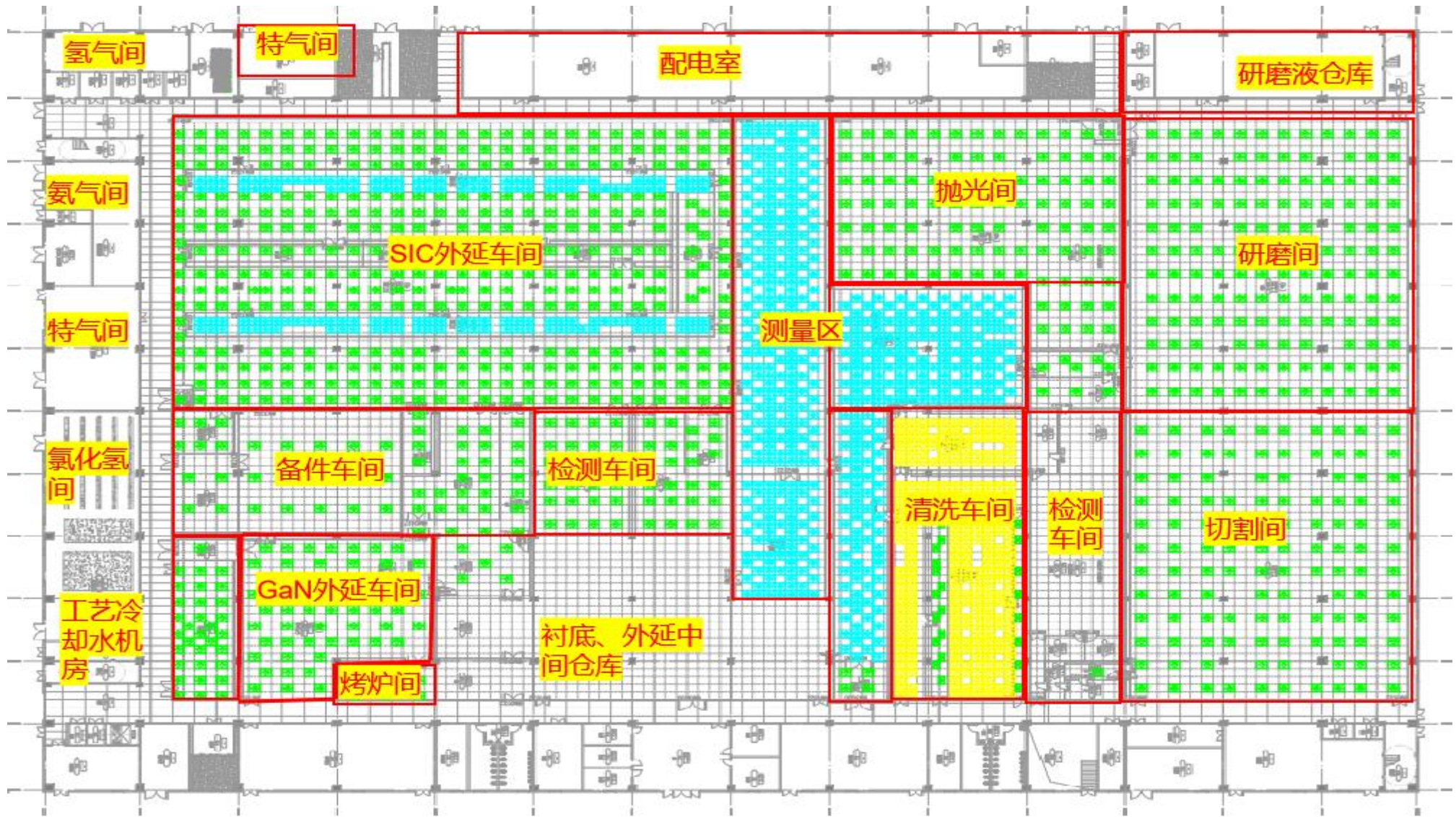
附图 5 外延衬底平面布置图
