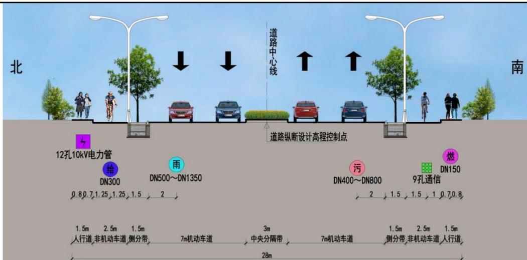
图 2-17 管线横断面图（常规段）
