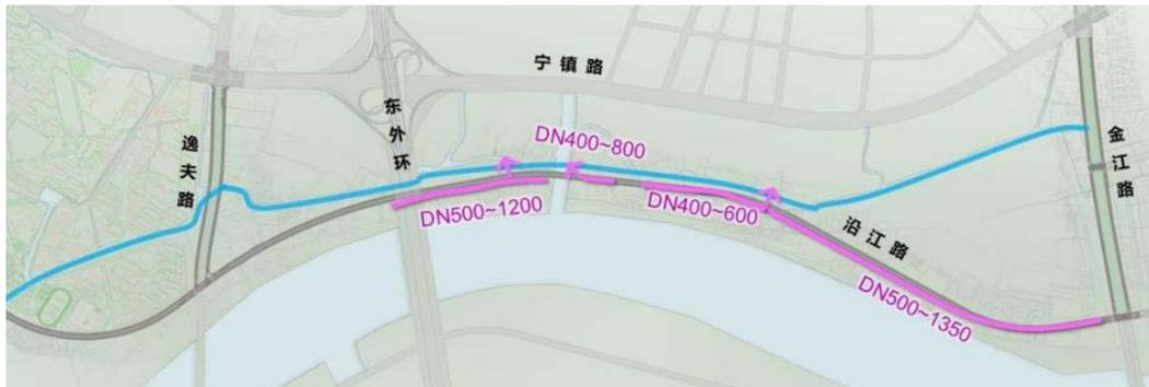
图 2-15 雨水排向示意图
