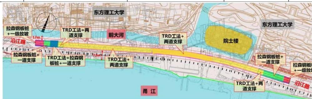
图 2-24 隧道基坑围护平面布置图
