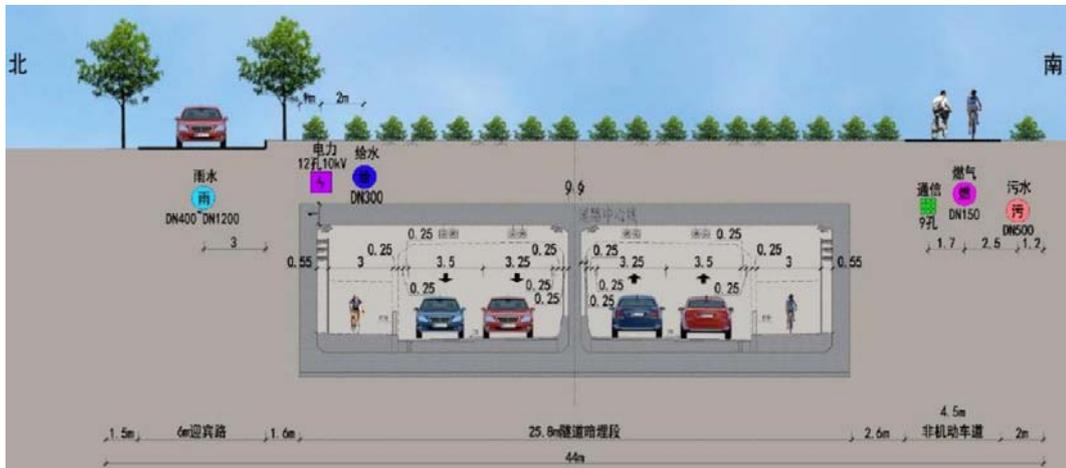
图 2-19 管线横断面图（隧道暗埋段）
