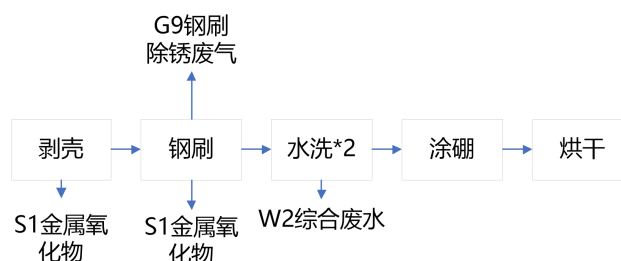
图 2-4 预处理线生产工艺流程图
