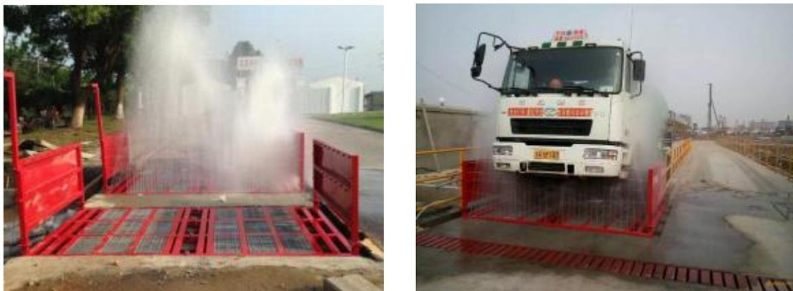
图表 5-4 车辆冲洗设备
