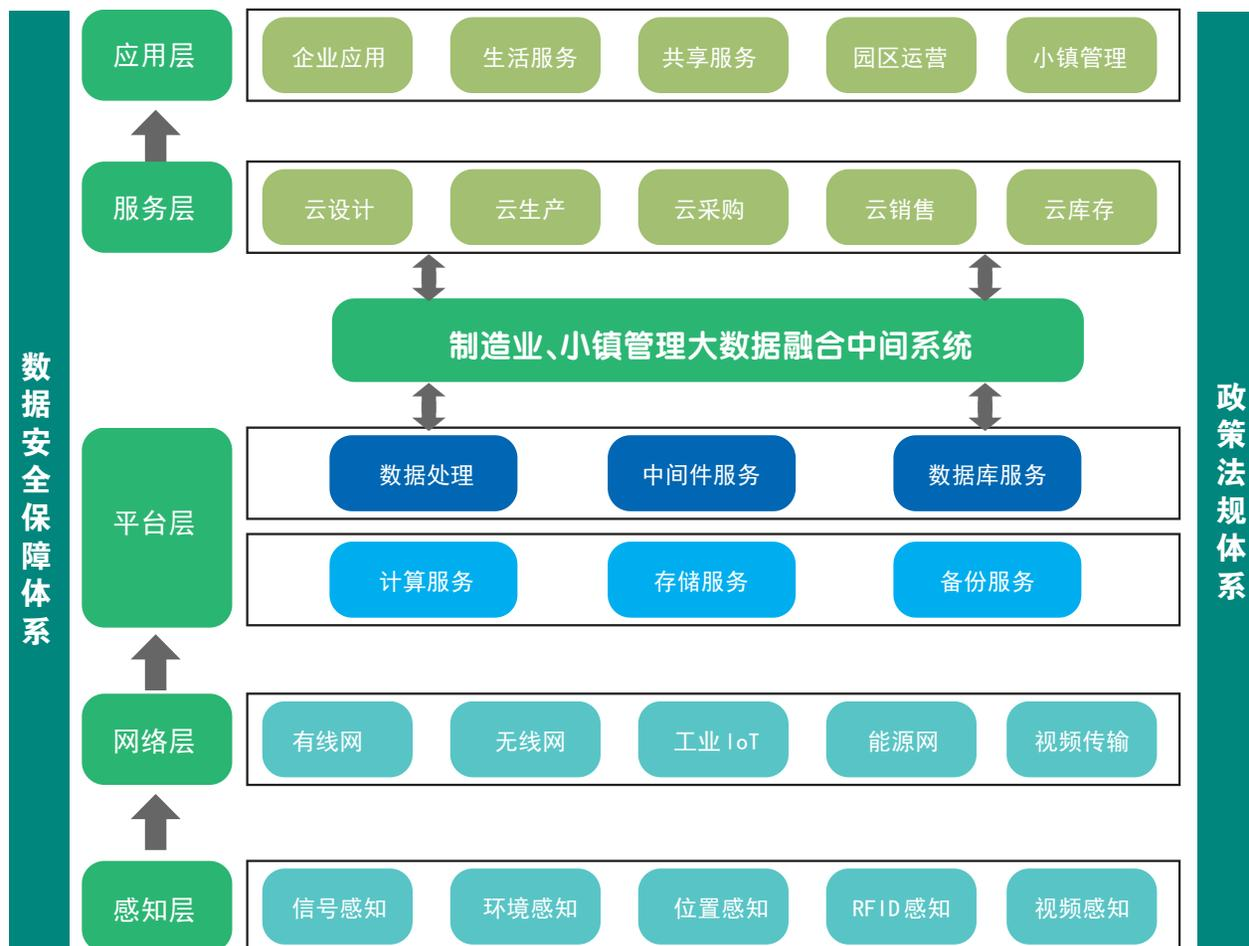
图3 制造业小镇数字化平台技术架构
