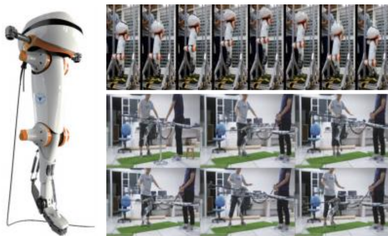
图5 单腿机器人高能效跳跃与动态平衡控制
