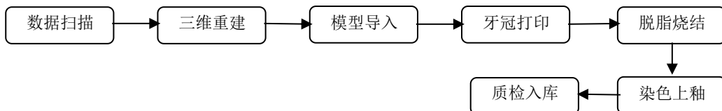
图 2-7 光固化 3D 打印义齿牙冠生产工艺流程图
