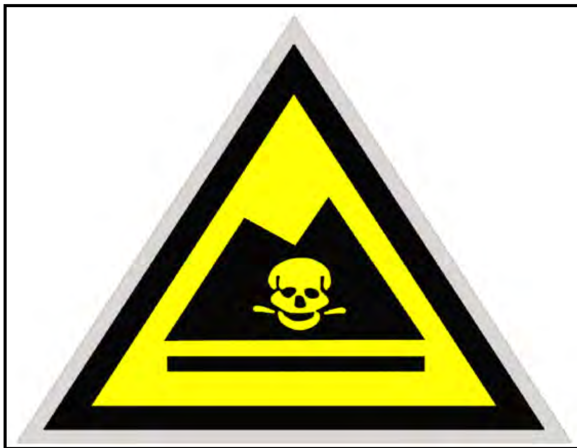
图 7.2.4-3 危险废物警示标志样式图
