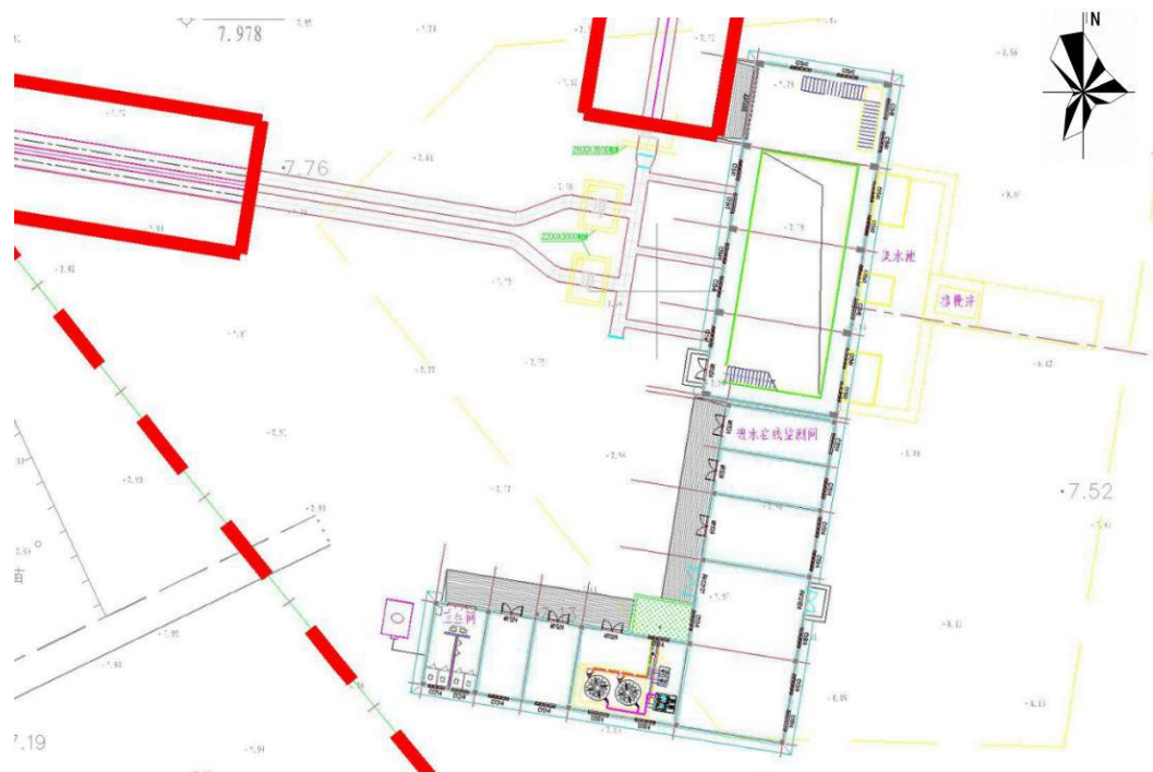
图 2-12 泵站总平布置
