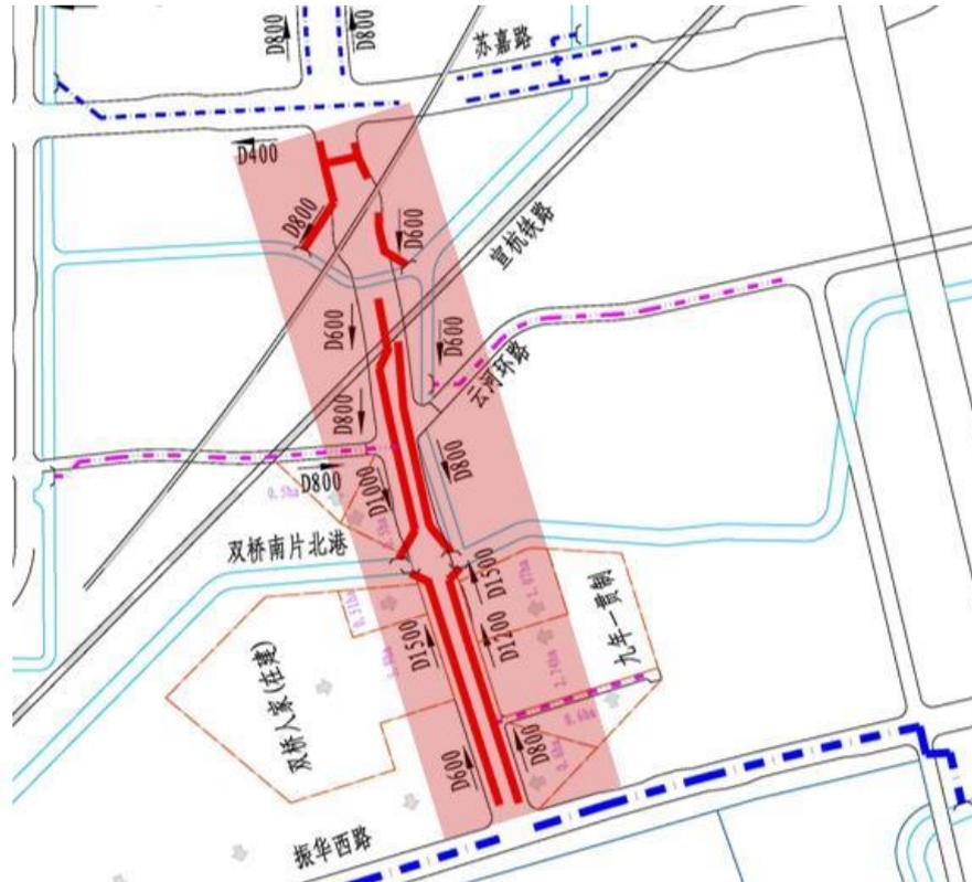
图 2-6 雨水设计系统图
