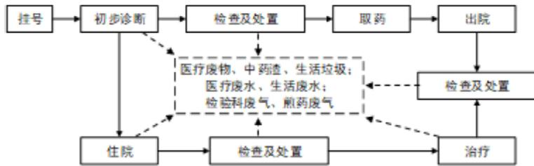
图 2-2 诊疗流程及产污环节示意图
