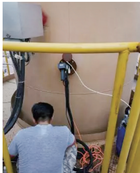
钱塘新区——阮劲峰 在20米高的新中纺定型车间废气排放口附近进行采样检测
