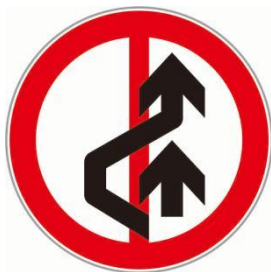
图 9 隧道禁止超车标志示例
