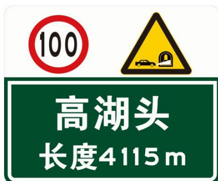
图6 除短隧道外隧道预告标志示例
