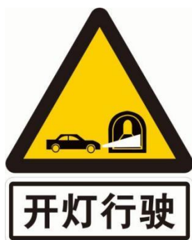
图7 隧道开车灯标志示例
