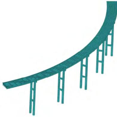
图2 高墩桥梁有限元模型
