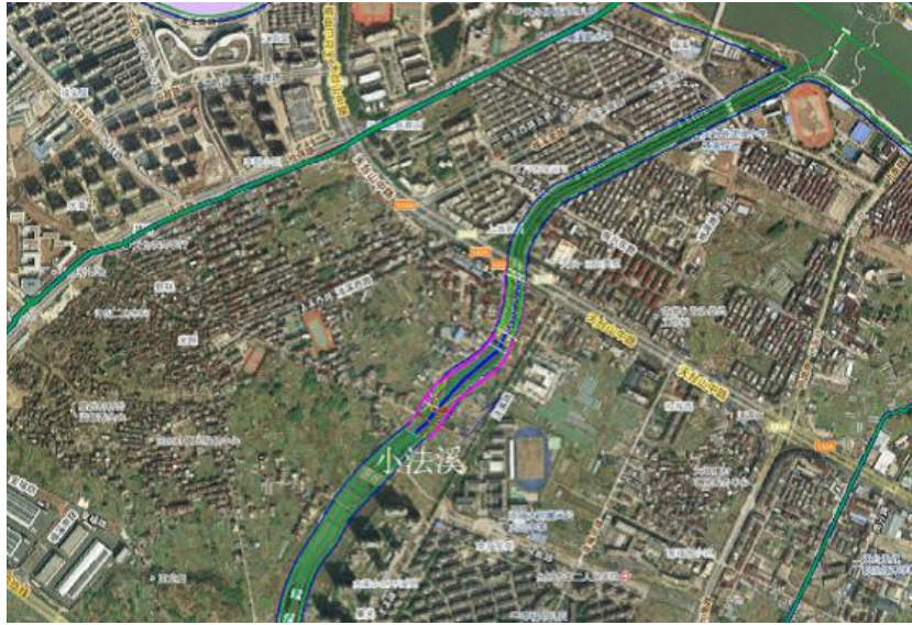
图 3.1-5 小法溪河道清淤范围 (0.45km)
