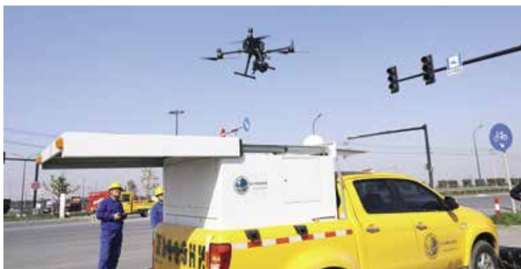
2021年,柯桥区马鞍街道实现电力配电网线路无人机自主巡检全覆盖 (柯桥供电分局 提供)
