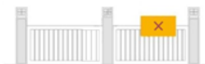
图 A.7 围墙广告设施不正确的设置示例
