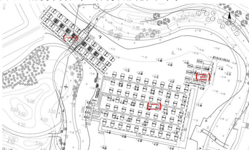
图 2-2 曝气装置布置图
