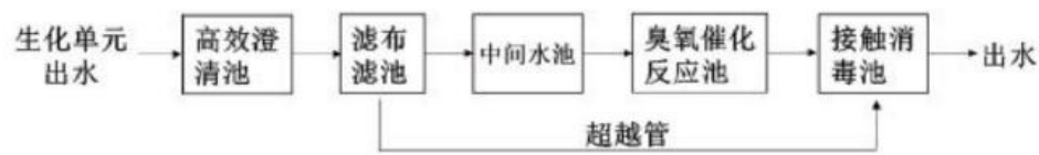
图 4.3-2 申和水务提标改造工艺流程
