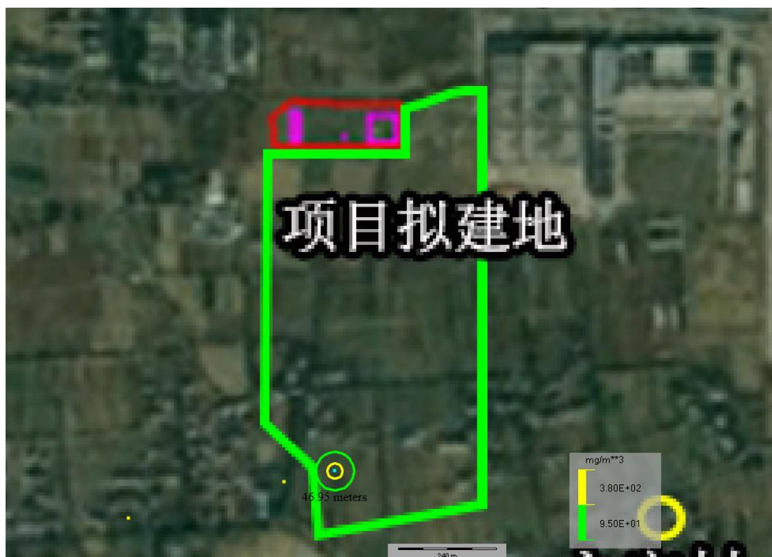
图 5.3-14 乙醛储罐泄漏引发火灾最常见气象条件下 CO 扩散预测结果
