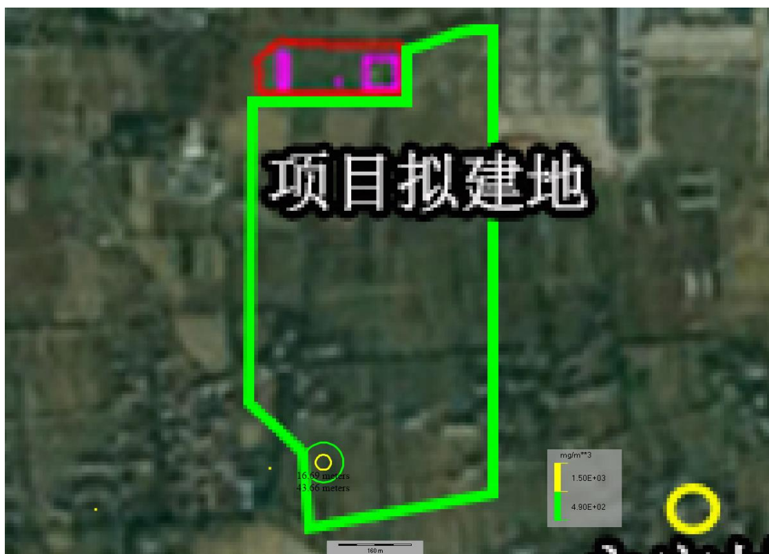
图 5.3-8 乙醛储罐连接管道泄漏事故最常见气象条件下乙醛扩散预测结果
