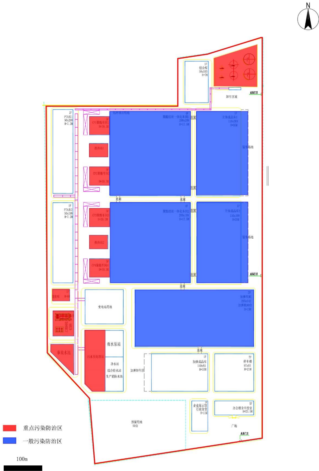
图 6.5-1 本项目实施污染地下水分区防渗图
