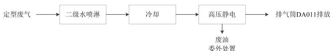
图 6.3-1 定型工序废气处理工艺流程图
