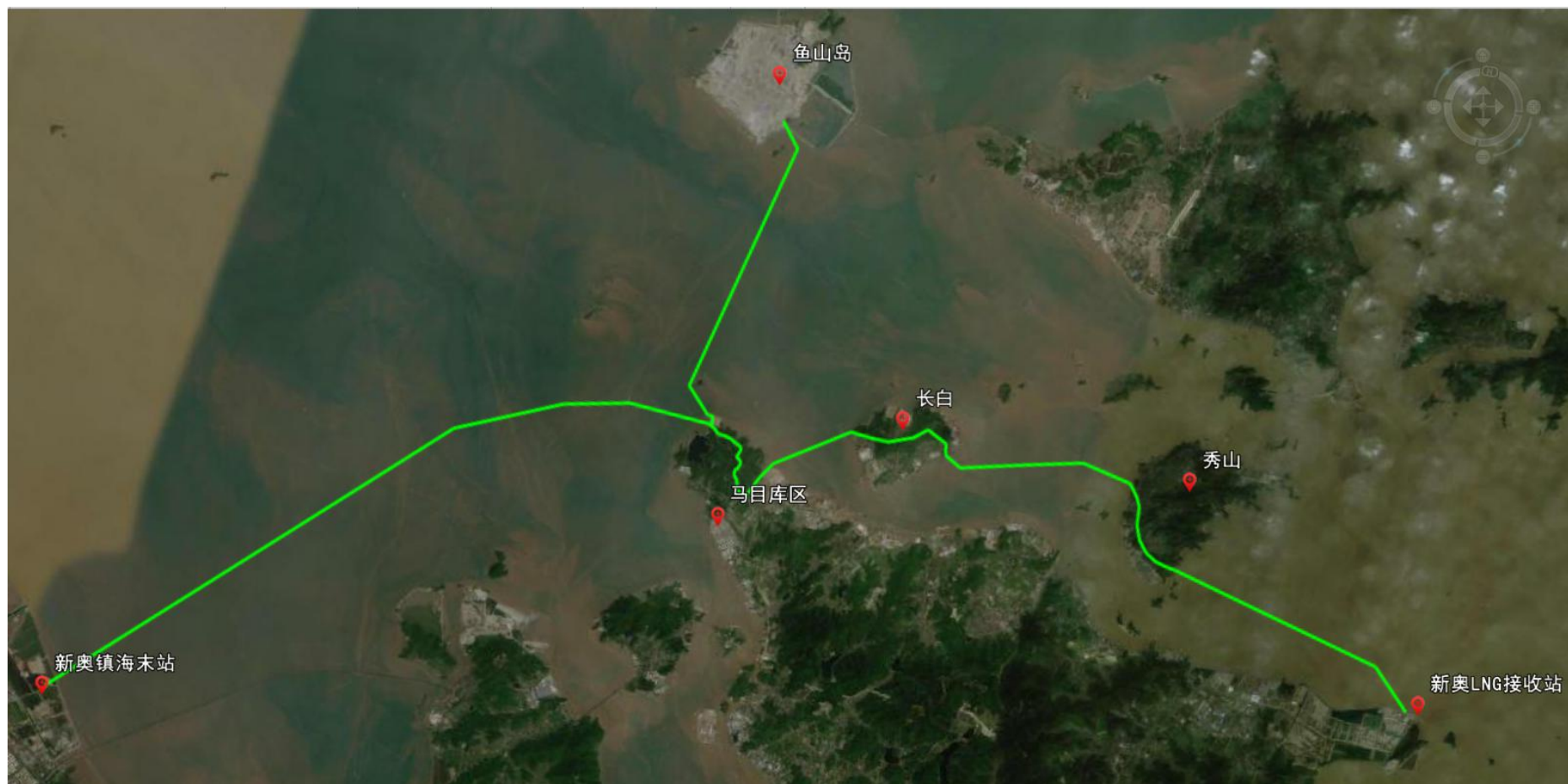
附件3 马目-鱼山海底输气管道路由图
