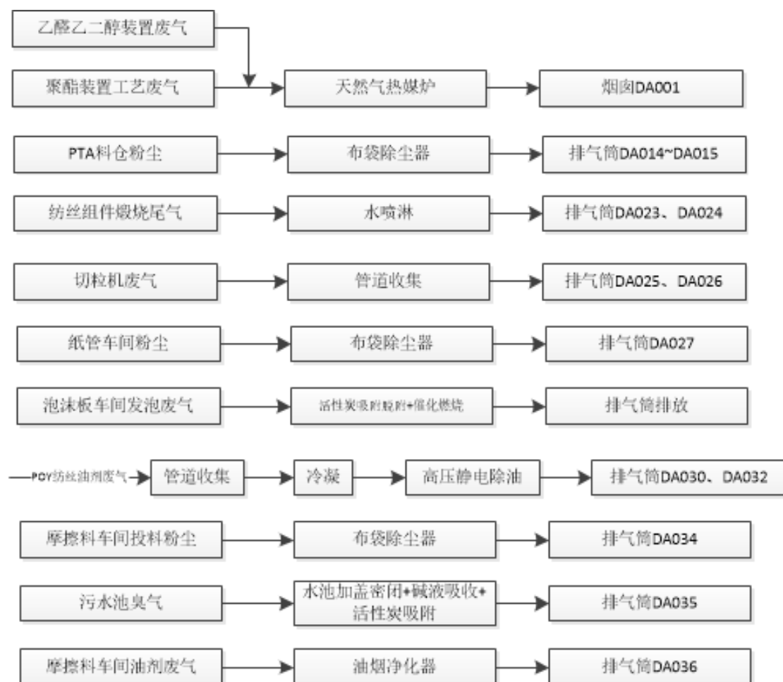
图 3.2-10 POY 厂区废气排放路线
