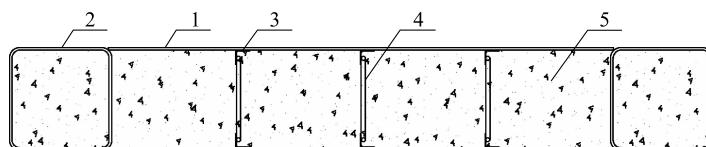
1—外侧钢板；2—转角方钢管；3—连接角钢；4—钢筋桁架；5—腔内混凝土
