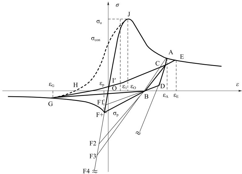
图 B. 0.3 混凝土应力-应变滞回关系曲线示意图
