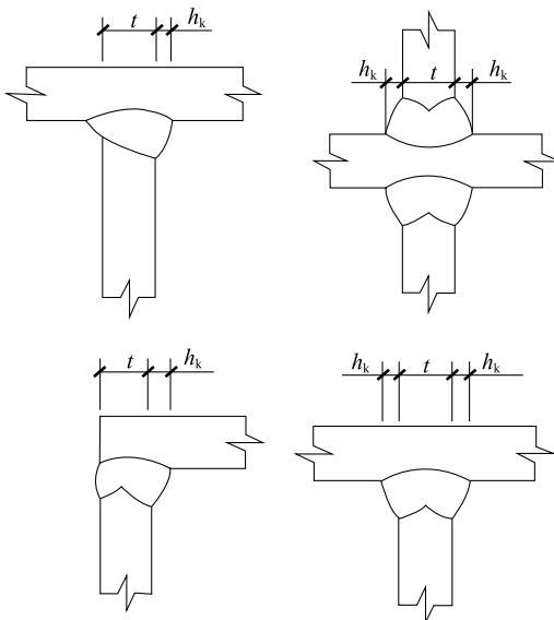
图 11.3.4 对接和角接组合焊缝
