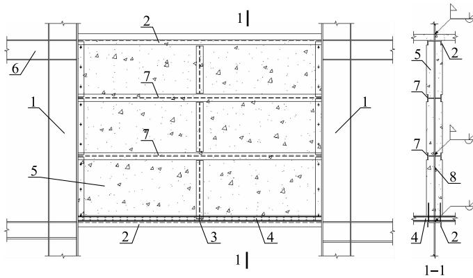
图 6.1.2 防屈曲钢板墙构造示意图
