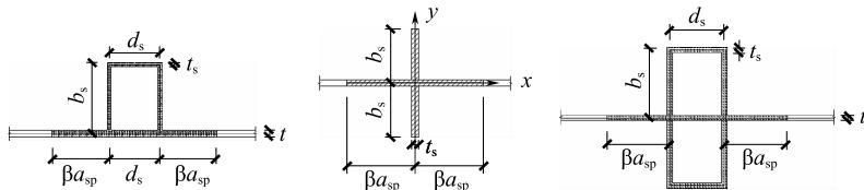
图 5.2.2 加劲肋-墙板有效截面的组合压杆截面示意图
