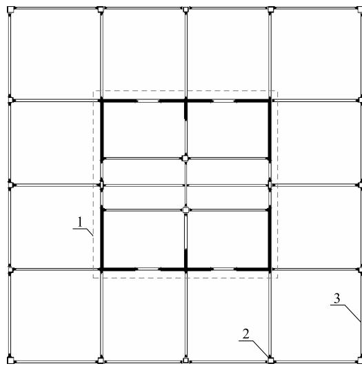
图 2-2 钢框架-钢板墙核心筒结构
