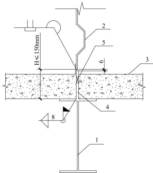
图 8.2.5-2 波形钢板与外框梁的焊接连接
