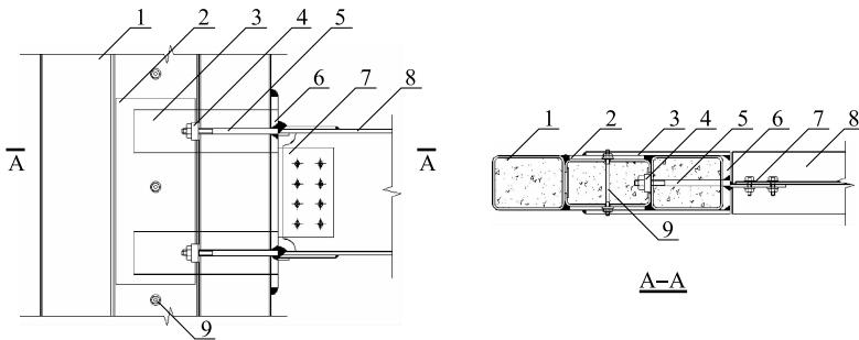
图 8.5.4 钢梁与钢板组合墙锚筋式刚接节点
