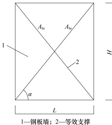
图 A. 0.1 钢板墙等效支撑模型
