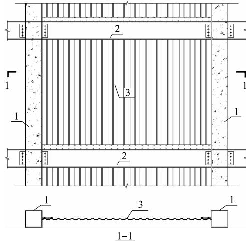
图 4.4.2 坚放波形钢板墙示意图
