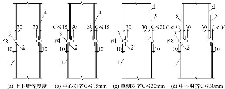
图 8.3.3 钢板组合墙不同墙厚对接做法
