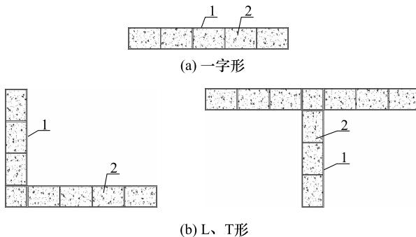
图 7.1.2 封闭多腔钢管混凝土组合墙
