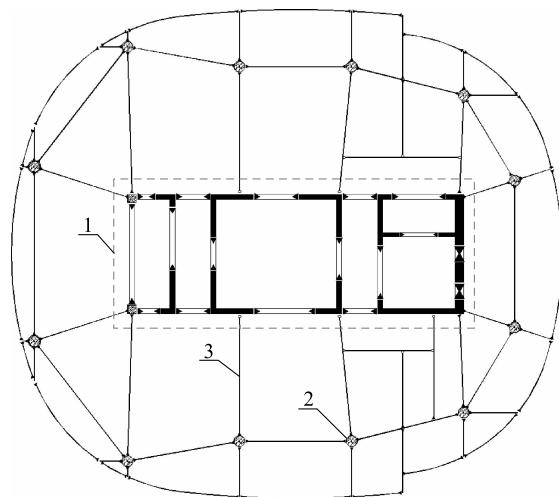
图 2-5 钢框架-钢板组合墙核心筒结构
