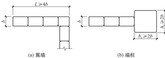
图 7.4.1 封闭多腔钢管混凝土组合墙的翼墙和端柱
