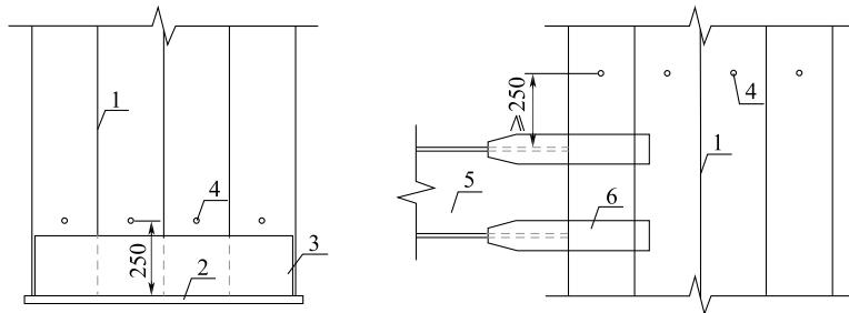
图 9.1.6 排气孔的构造
