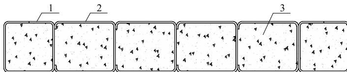
1—矩形冷弯钢管；2—U形冷弯钢管；3—腔内混凝土
