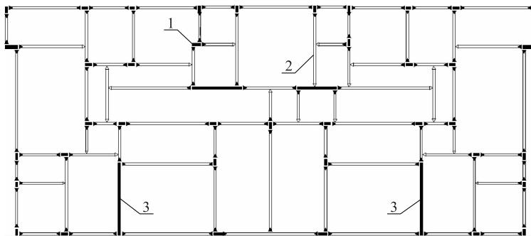
图 2-1 钢框架-钢板墙结构
