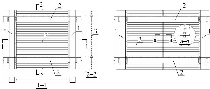
图 4.3.1 横放波形钢板墙示意图
