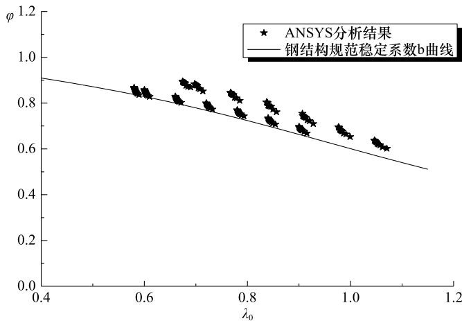
图 7-7 一字形钢板组合墙的  $\varphi - \lambda_0$  关系
