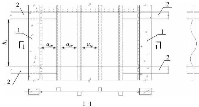
图 5.2.2-1 仅设置竖向加劲肋的钢板墙示意图
