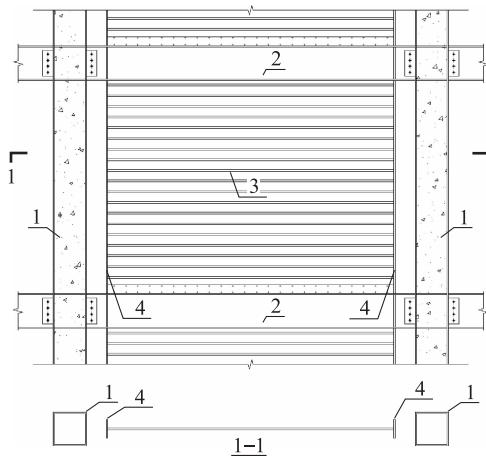
图 4.3.4 横放波形钢板墙的边框构件设置
