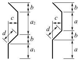
图 3.6.9 波形钢板尺寸示意
