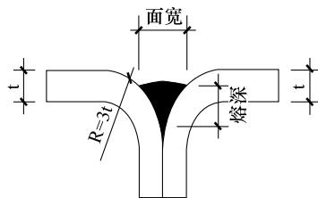
图 7-12 焊缝示意图
