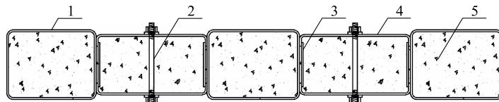
1—长方形钢管；2—对穿螺栓；3—缀板；4—窄翼缘槽钢；5—腔内混凝土
