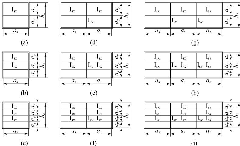
图6.1.1 防屈曲钢板墙的加劲肋布置示意图
