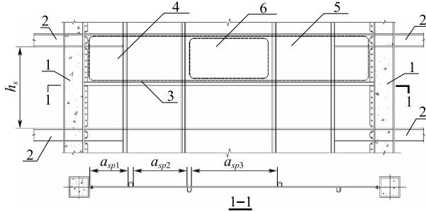
图 5.2.4 同时设置横向和竖向加劲肋的钢板墙示意图
