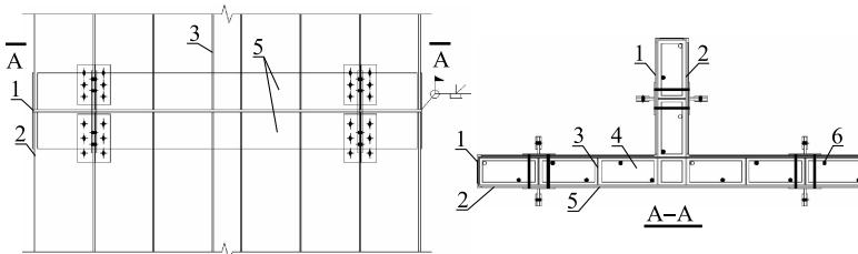
图8.3.2 钢板组合墙现场拼接节点
