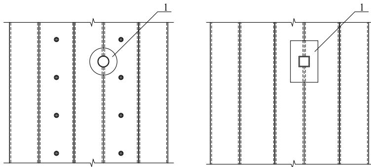
图 7.4.9 钢管墙洞口贴板补强
