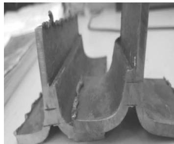
图 7-11 实际焊缝
