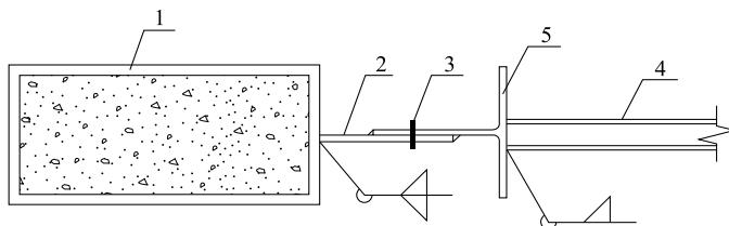
图8.2.5-1 与外框架柱用鱼尾板的焊接连接示意图
