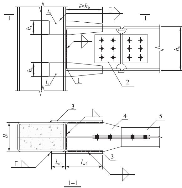
图 8.5.3 贴板式梁柱刚接节点示意
