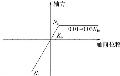
图 A.0.2 钢板墙等效支撑轴力-轴向位移关系曲线
