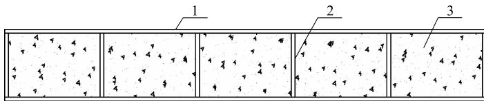
1—外侧钢板；2—肋板；3—腔内混凝土
