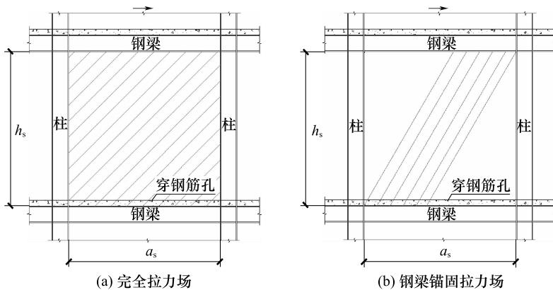
图 4-1 钢板墙的拉力场
