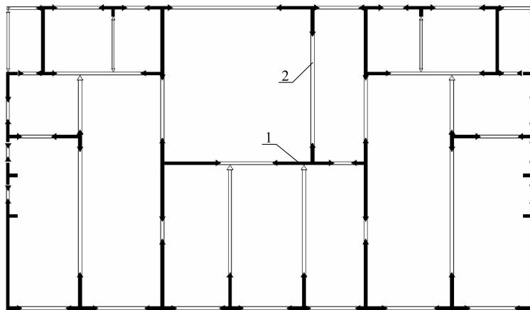
图 2-3 钢板组合墙结构
