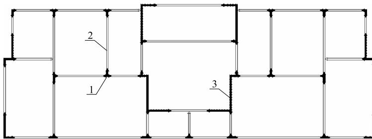
图 2-4 钢框架-钢板组合墙结构
