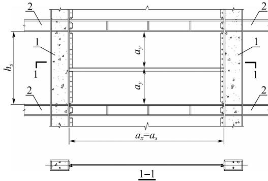
图 5.2.3 仅设置横向加劲肋的钢板墙示意图
