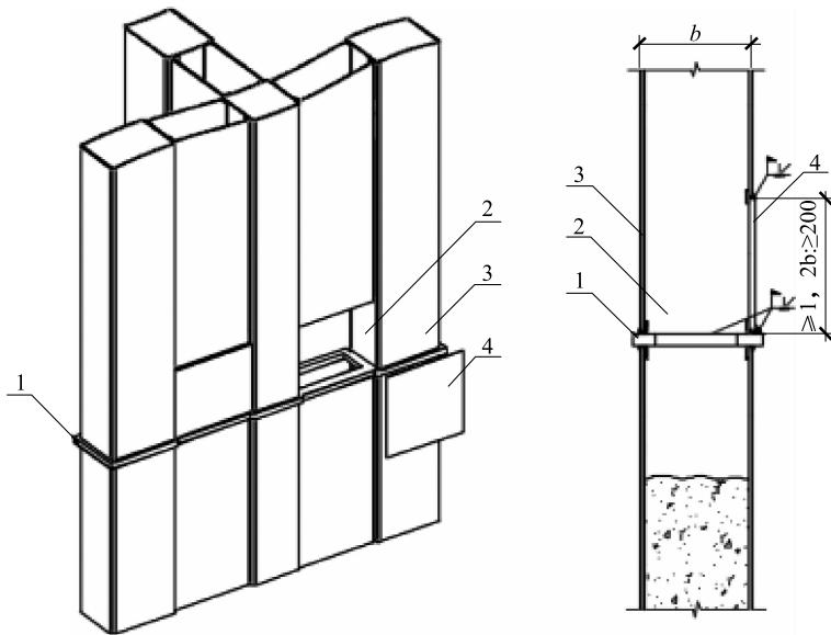
图 8.3.4 腔内分隔板焊接示意
