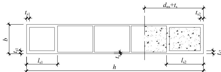
图 7-4 端部加强时组合墙计算截面和图示
