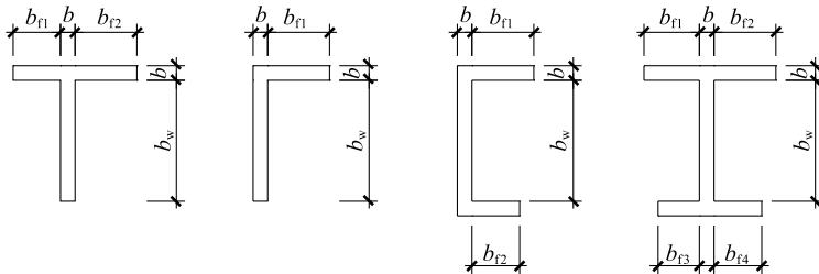
图 7.3.6 封闭多腔钢管混凝土组合墙腹板墙肢和翼缘墙肢的厚度、长度示意
