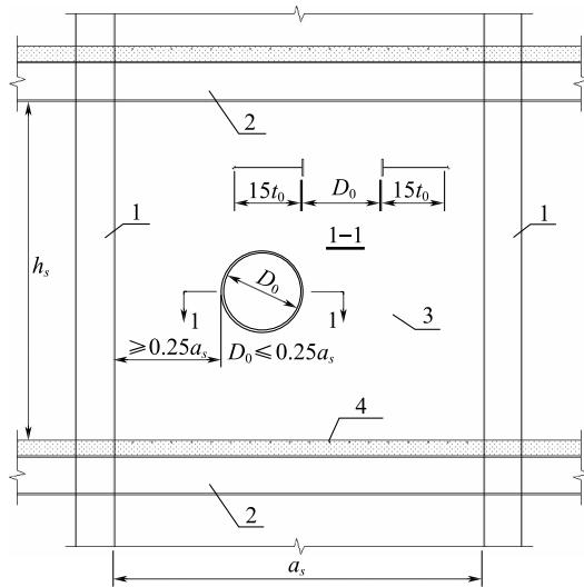
图 4.2.11 钢板墙的开孔构造
