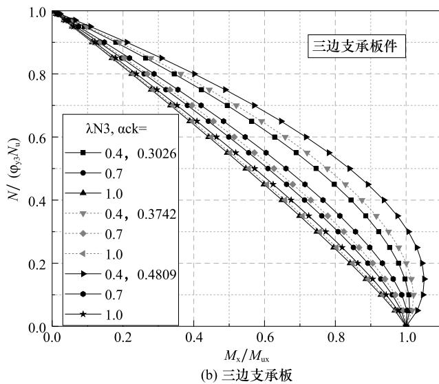
图 7-10 墙肢压弯相关关系
