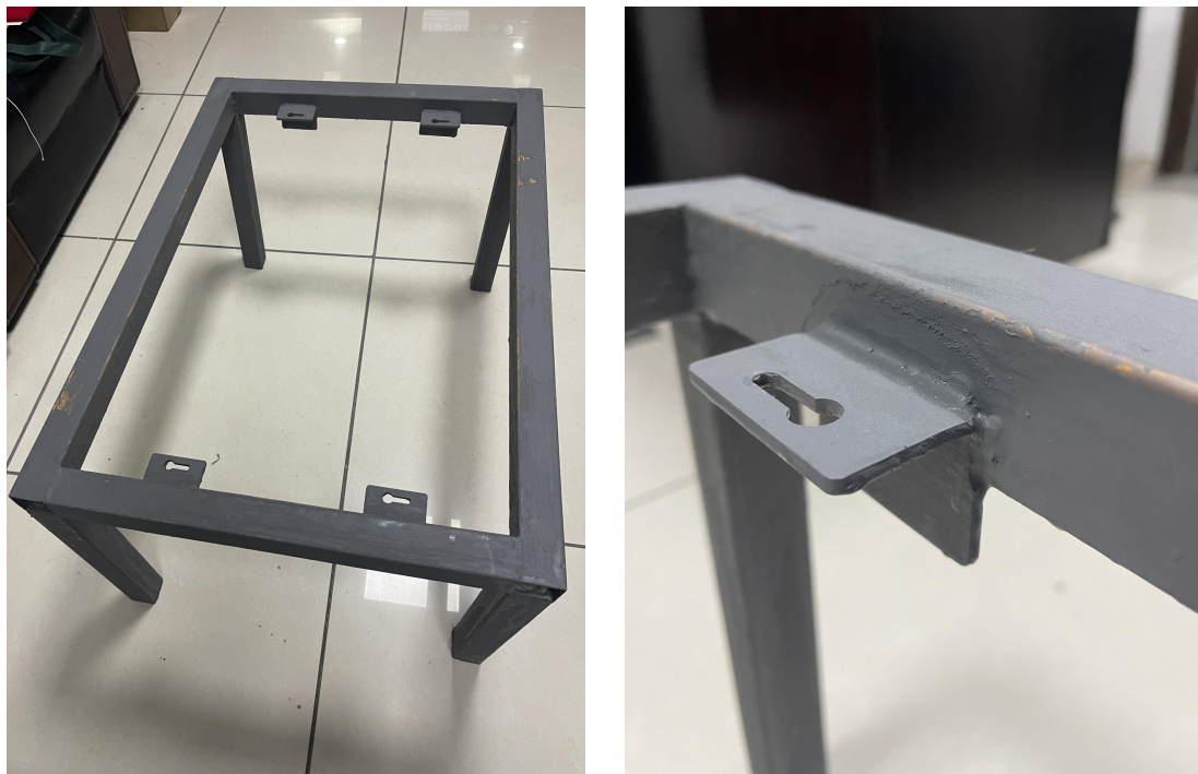
图 5.2.3 台下盆钢架样品
