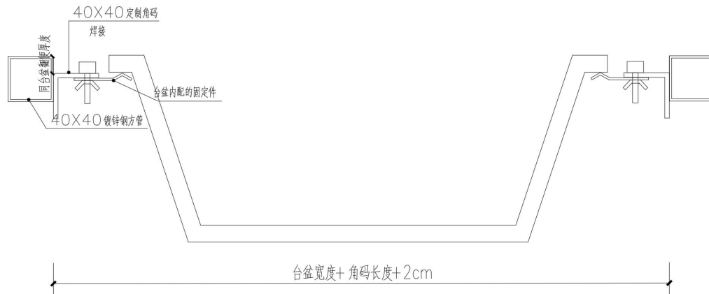
图 5.2.2 台下盆钢架深化图纸
