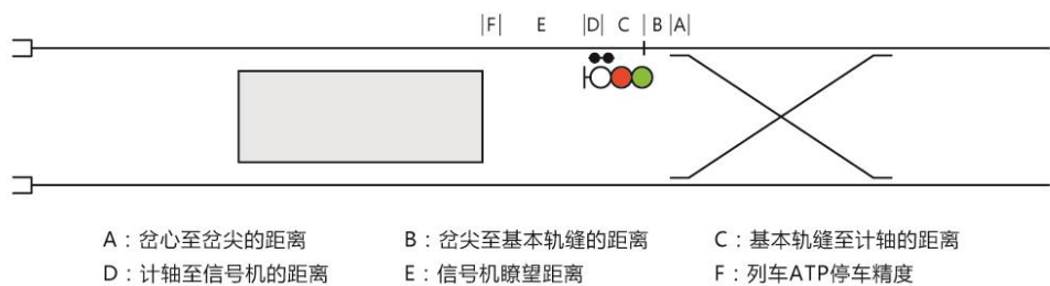
图 7.2.4-1 车站站台有效长度端部与相邻对向道岔设置示意图
