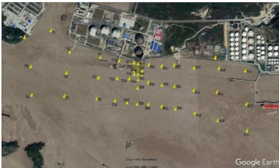
图 3.7-3 2019 年上海液化天然气项目一期工程冷排水扩散场监测站位示意图
