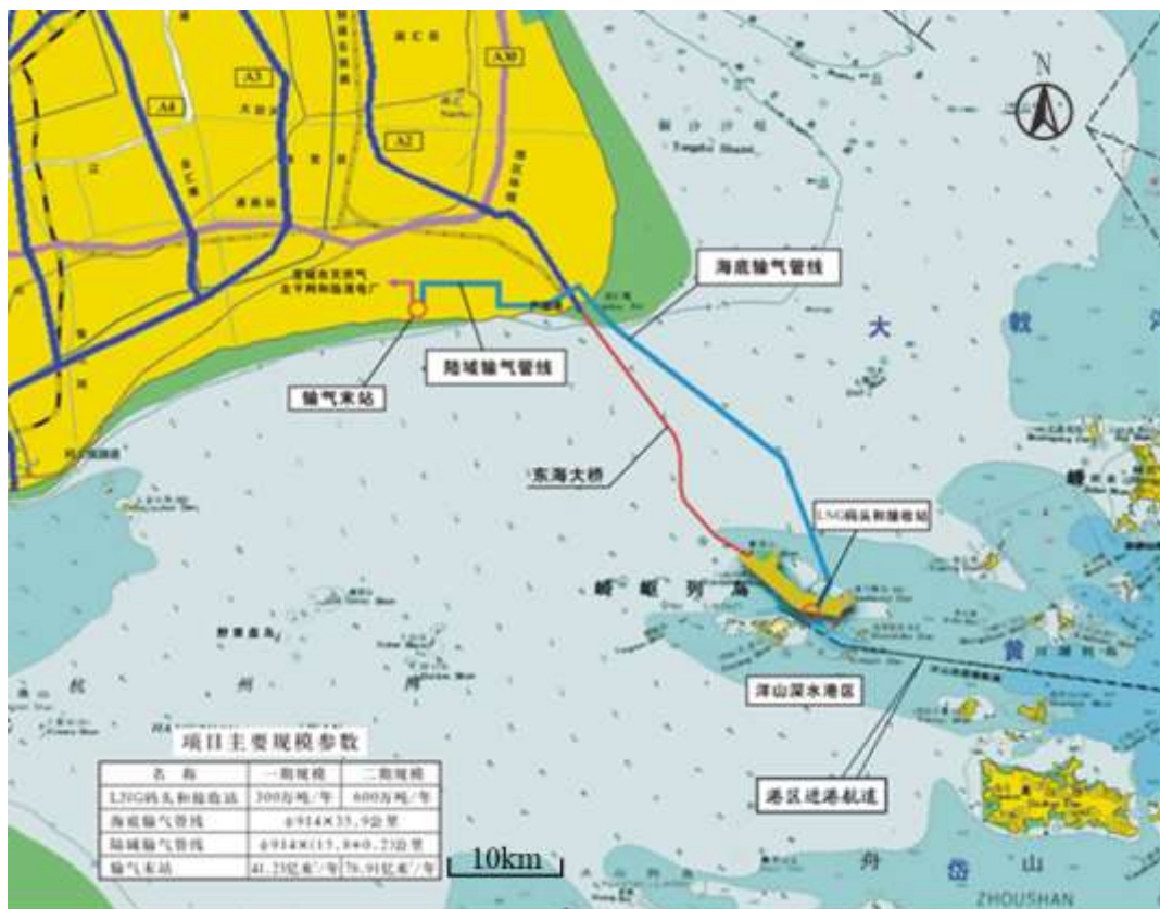
图 3.1-1 上海 LNG 站线项目总体布置图
