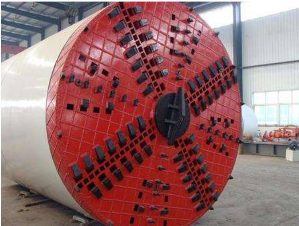
图 4.3-24 泥水平衡顶管机工具头
