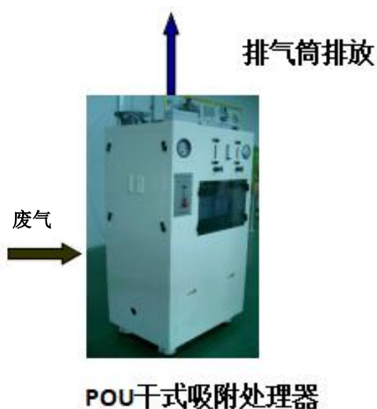
图 16 磷烷及三氟化硼废气处理流程示意图
