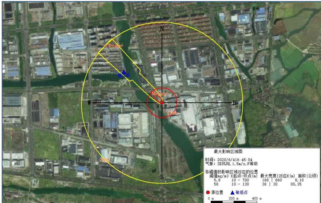
图 6 氯气预测浓度达到不同毒性终点浓度的最大影响范围图
