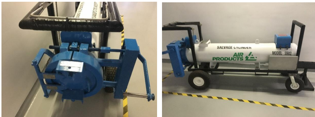
图 10 钢瓶泄漏处理车（俗称铁棺材）
