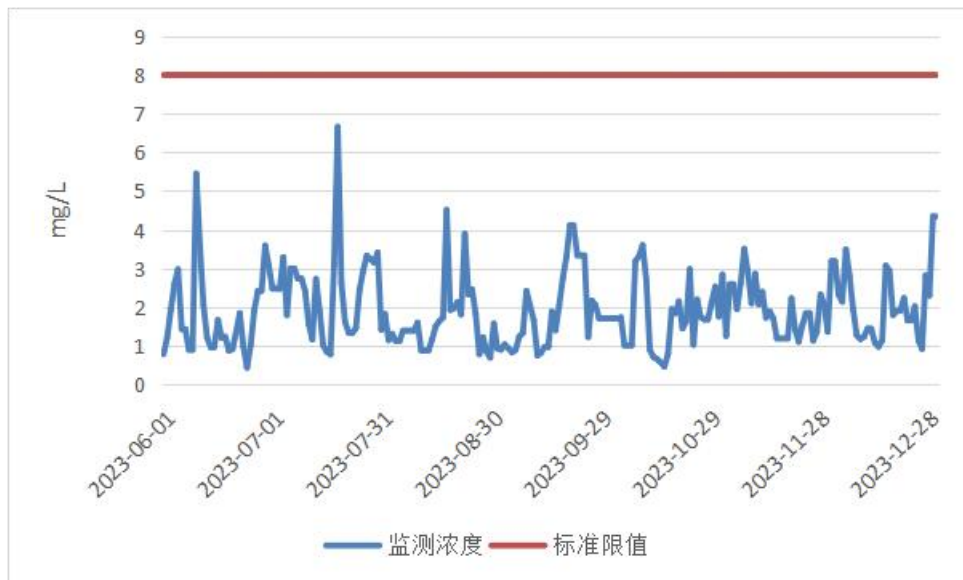
图 3.6.4-7 污水处理站总排口总磷在线监测数据（日均值）
