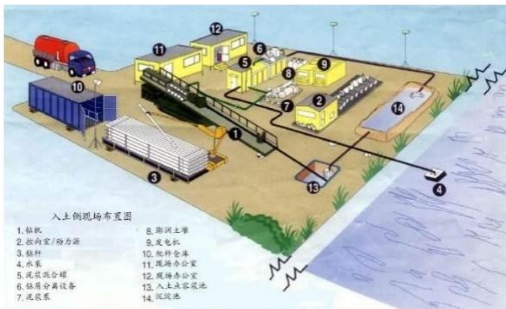
图 3.8-4 定向钻入土点施工现场布置示意图
