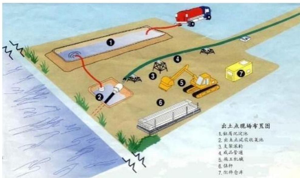
图 3.8-5 定向钻出土点施工现场布置示意图
