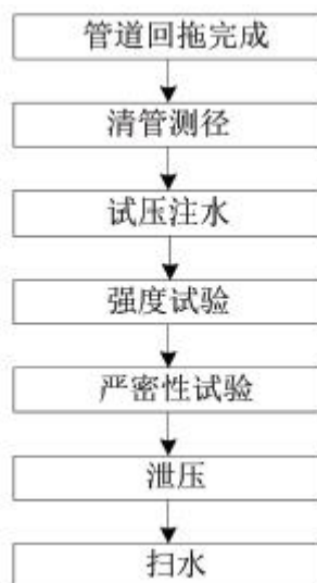
图 3.8-3 清管、测径、试压作业流程图
