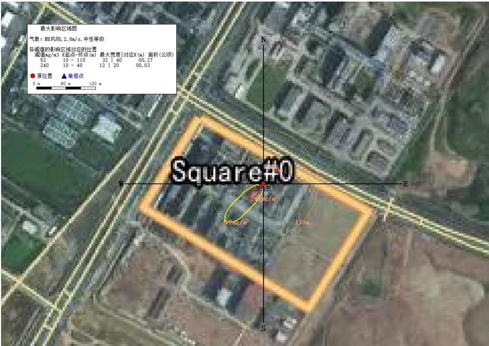
图 6.3-15 甲基二氯硅烷泄漏风险预测结果图（最常见气象条件下）
