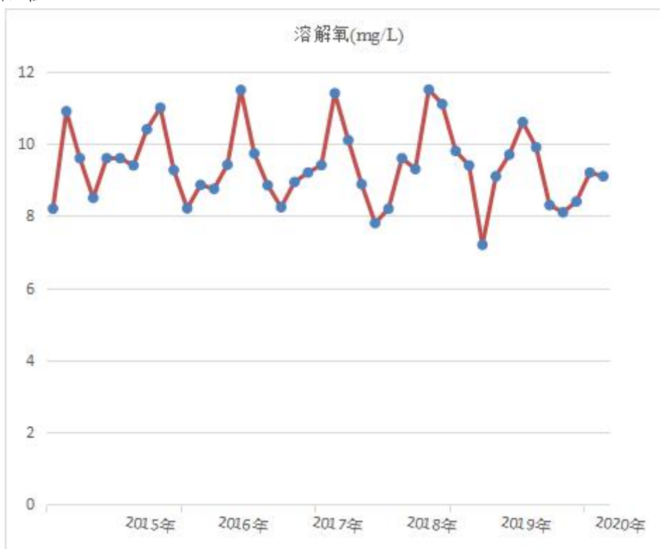
图 4.2-1 常山港溪东断面 2015~2020 年溶解氧变化趋势
