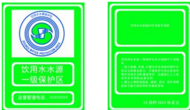
图7.1-2 饮用水水源保护区界标正面与反面示意图
