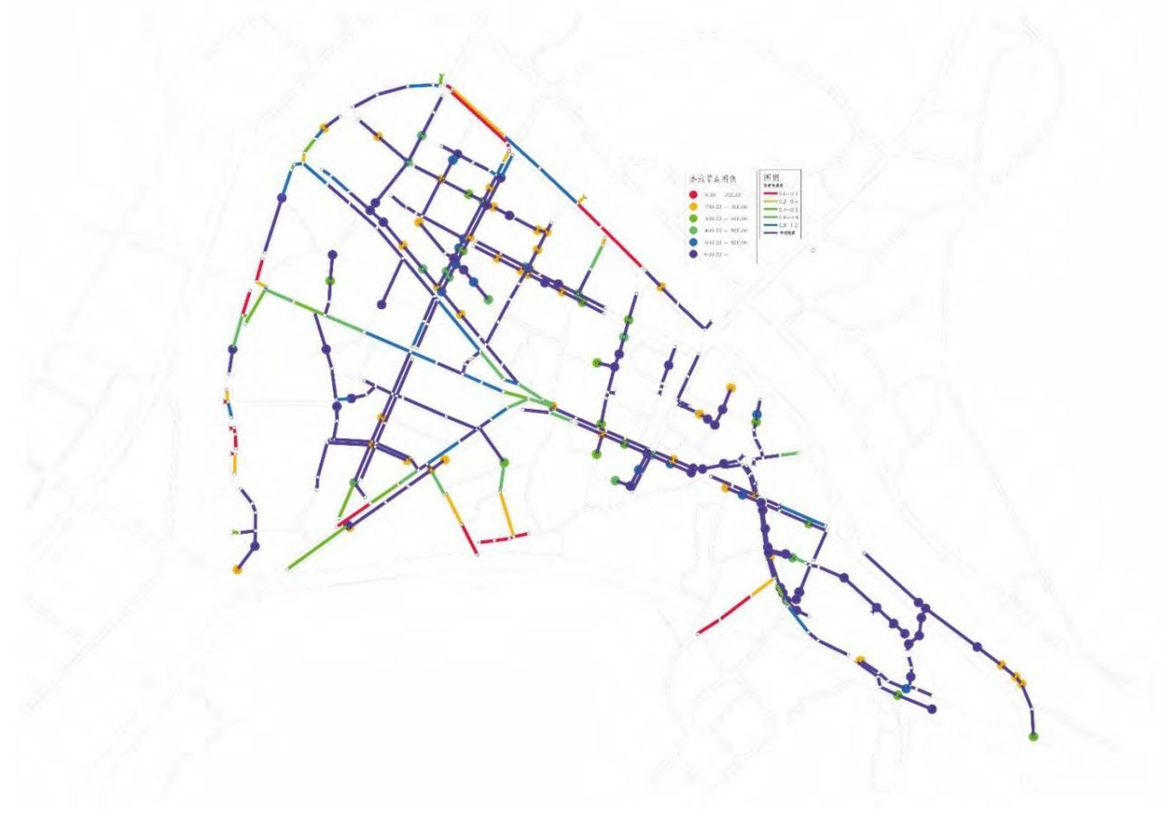
图 4.7-25 老城区管网溢流分析图
